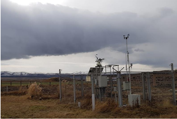
Նկար 1. Մասրիկ-1 արևային ֆոտովոլտային կայանի համար տեղադրված մետեոկայան
